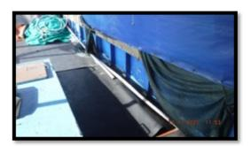
Gli scalmotti sui quali poggia la falchetta, protetta da profilato in acciaio, versano in stato di carente manutenzione, al pari del piano di coperta.
