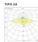
Ottica asimmetrica. Illuminazione per installazioni stradali o percorsi ciclo-pedonali.
