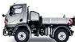
L'autocarro è una macchina utilizzata per il trasporto di mezzi, materiali da costruzione e/o di risulta da demolizioni o scavi, ecc., costituita essenzialmente da una cabina, destinata ad accogliere il conducente ed un cassone generalmente ribaltabile, per mezzo di un sistema oleodinamico.
