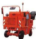
Le frese stradali vengono utilizzate per il ripristino dell'asfalto dopo il gelo invernale, ma anche per fresature di scavi per posa di servizi e o cancellazione di segnaletica stradale. Dotate di motore diesel, consentono diverse profondità e larghezze di fresatura.
