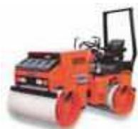
Il rullo compressore o compattatore è una macchina, utilizzata prevalentemente nei lavori stradali, costituita da un corpo semovente, la cui traslazione e contemporanea compattazione del terreno o del manto bituminoso, avviene mediante due o tre grandi cilindri metallici (la cui rotazione permette l'avanzamento della macchina) adeguatamente pesanti, lisci o, eventualmente (solo per compattazione di terreno), dotati di punte per un'azione a maggior profondità.
