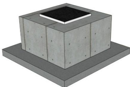
Il plinto prefabbricato viene realizzato in stabilimento attraverso casseforme reimpiegabili in acciaio.
