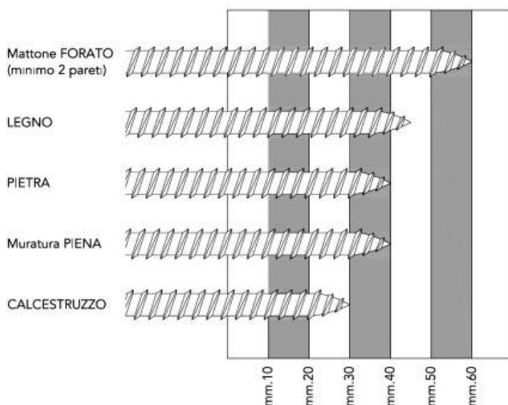
La lunghezza totale della vite, sarà individuata aggiungendo lo spessore del controltaio e dello spazio tra controltaio e muro.
