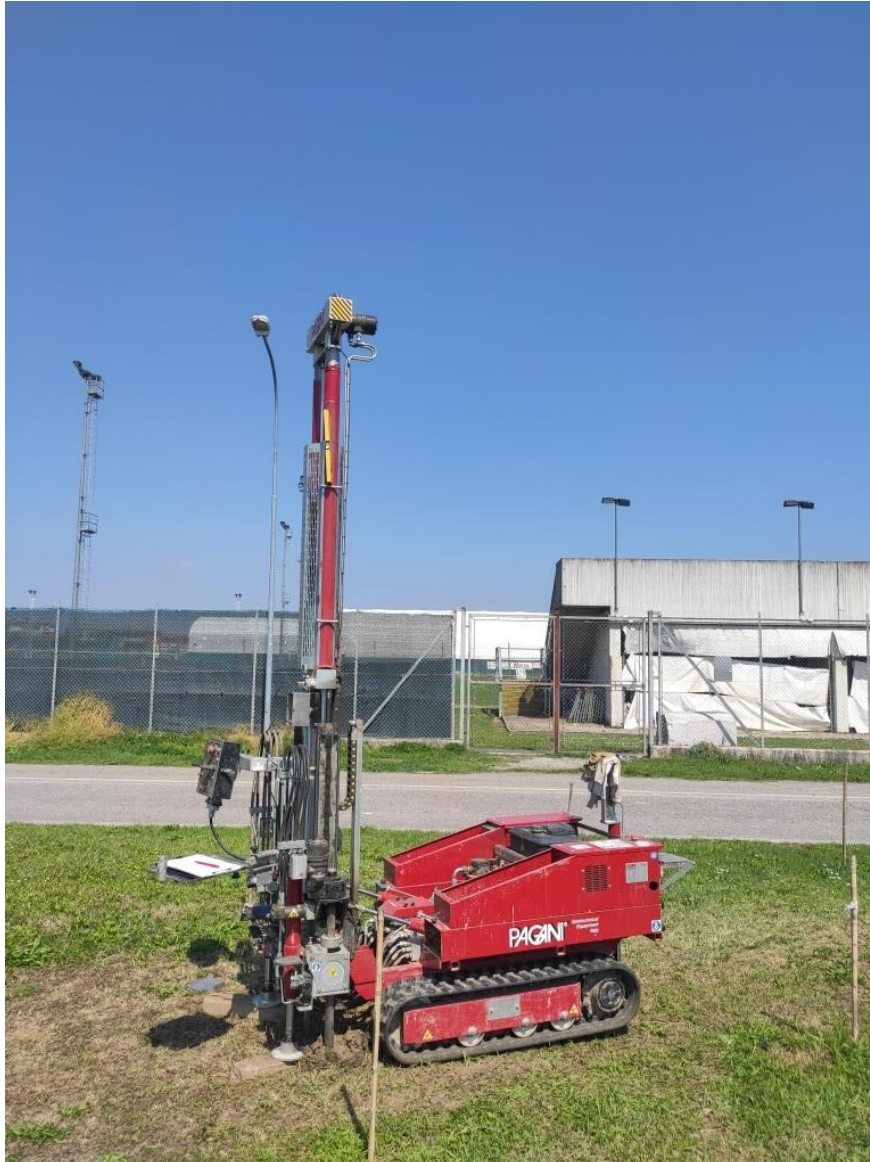
Figura 8: esecuzione della prova penetrometrica statica CPT in corrispondenza dell'area di prossimo intervento in comune di Musile di Piave, il 05/05/2023
