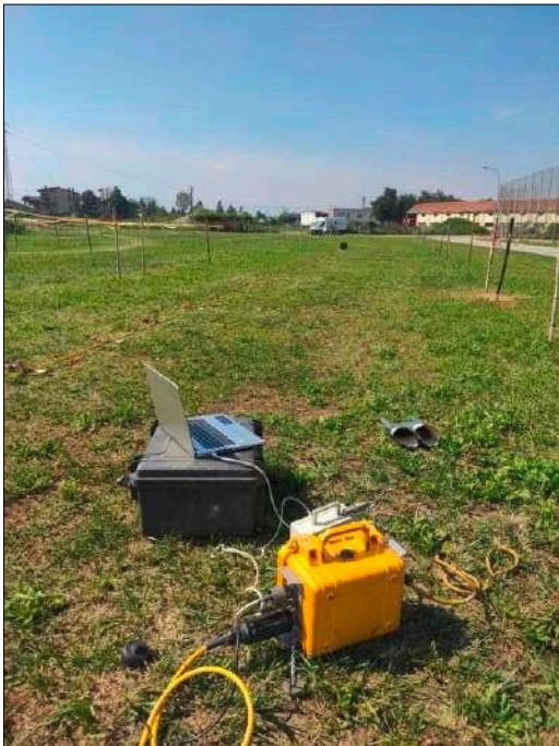
Acquisizione del segnale sismico mediante Sismografo Geometrics Mod. Geode 3-1000
