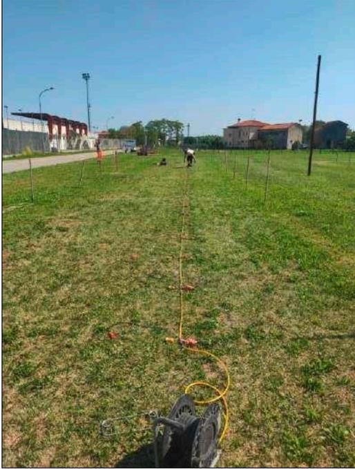
*Stendimento sismico M.A.S.W.*
