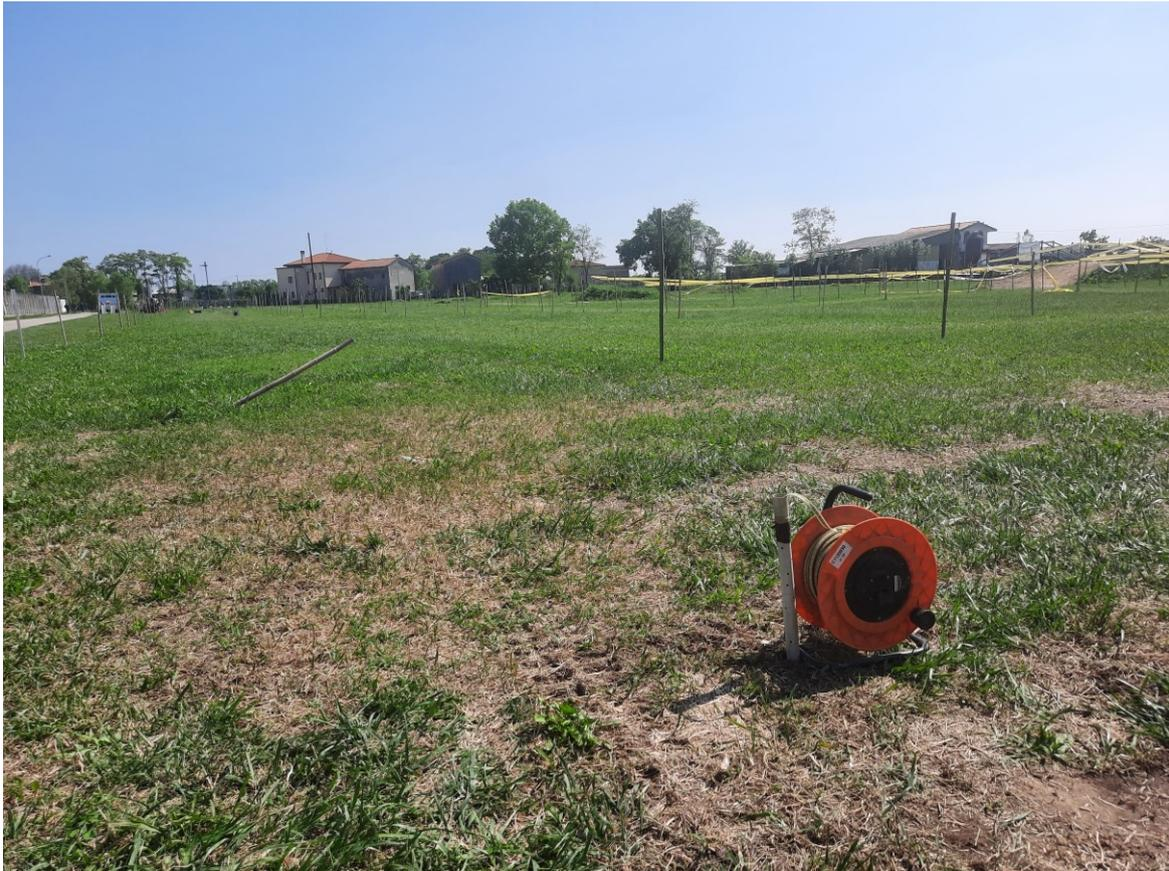
**Figura 5:** lettura freaticometrica in micropiezometro calato in foro di prova penetrometrica presso l'area investigata
