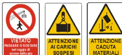
di macchine di sollevamento dovrà essere installata idonea cartellonistica sull'obbligo dell'uso dell'elmetto sotto il raggio d'azione del braccio del mezzo stesso e sul pericolo di caduta di materiali dall'alto come quella di seguito indicata.
