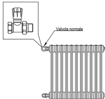
Particolare installazione valvole termostatiche
