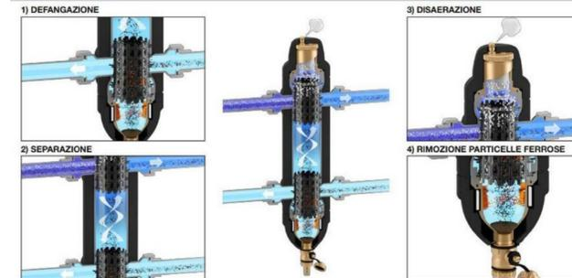
Viene prevista l'installazione di un separatore idraulico sul circuito primario esistente, al fine di separare idraulicamente il circuito primario, lato generatori di calore, dal circuito secondario, dal separatore idraulico sino ai singoli terminali.
